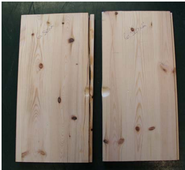
Testattu puinen ponttilautaseinä. Iskun seurauksen pontti murtuu
