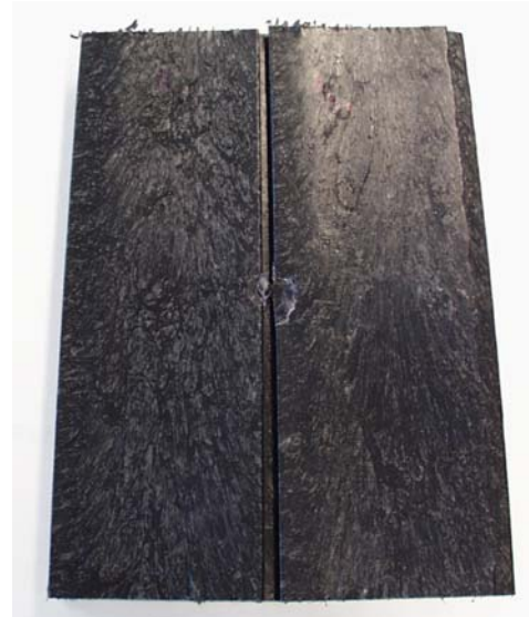
Testattu muovinen ponttilautaseinä. Ei vaurioita iskun jälkeen.
